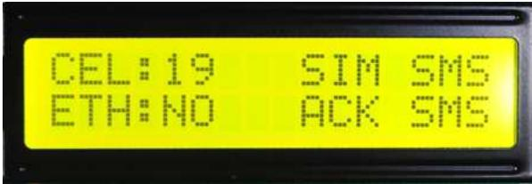
El ACK no llegó y la vía SMS se inhibe por el tiempo programado.
