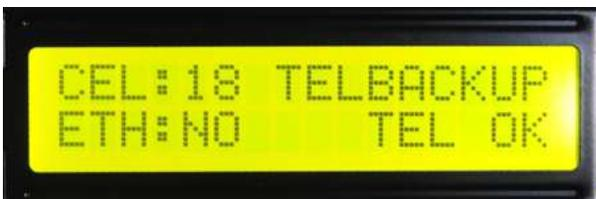
**Sección 8, opción 2:** Que haya línea telefónica no significa que la comunicación de la central de alarma por esta vía sea exitosa (puede fallar la línea de la estación de monitoreo, etc.) Este comunicador puede detectar dicho problema y al tercer intento fallido pasar el evento al buffer propio para intentar comunicarlo por las otras vías posibles, como GPRS, GSM, SMS.
