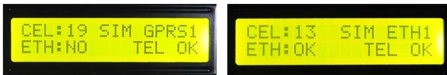
**Status de la comunicación:** Indica si la central esta conectada al simulador o en la línea. Si esta en el simulador muestra en que vía de comunicación y con que IP esta comunicando (de haber programado dos). Si esta conectada a la línea indicara si está en modo BACK UP.
